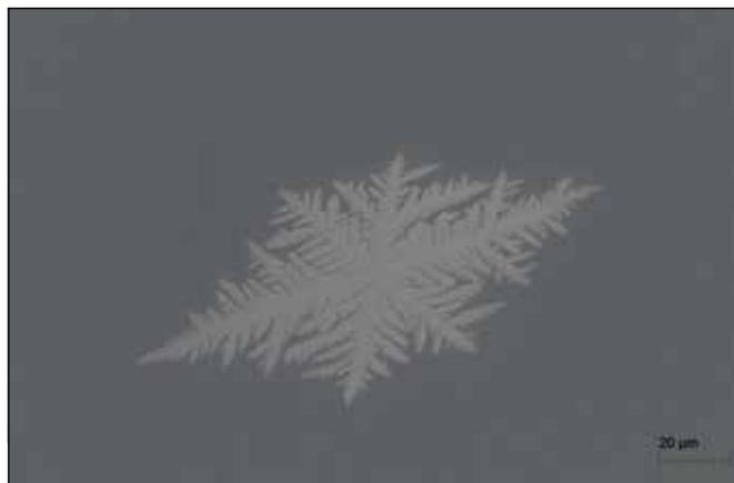
図1. 低圧力条件下かつ低水素フラックス比で合成したCu (111) 上の樹枝状グラフェン成長のSEM像。
