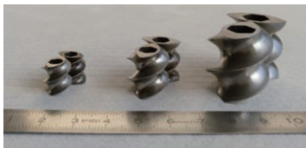
図3. 今回使用した3つのスケール: 11 mm、16 mm、24 mm のスクリーエレメント
