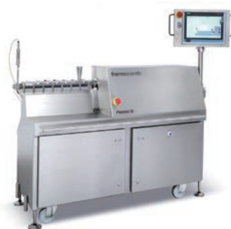
図2. Pharma 11 卓上型二軸スクリーエクストルーダー (左) ; Pharma 16生産スケール二軸スクリーエクストルーダー (右)。
