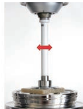
図4. HAAKE MARS 60レオメーターとプレート-プレート形状P35を使用した振幅と周波数(バルク)試験の設定
