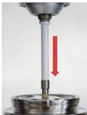
図3. HAAKE MARS 60レオメーターとプレート-プレート形状P8を使用した圧縮試験測定の設定
