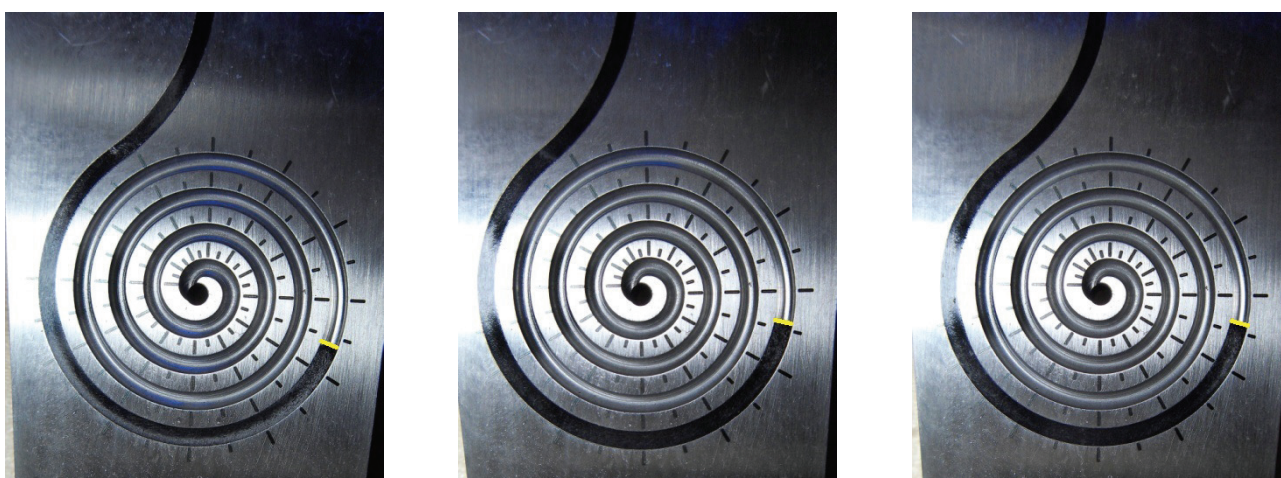
図4. サンプル2: その都度新しいものを使って3回成形を実施
