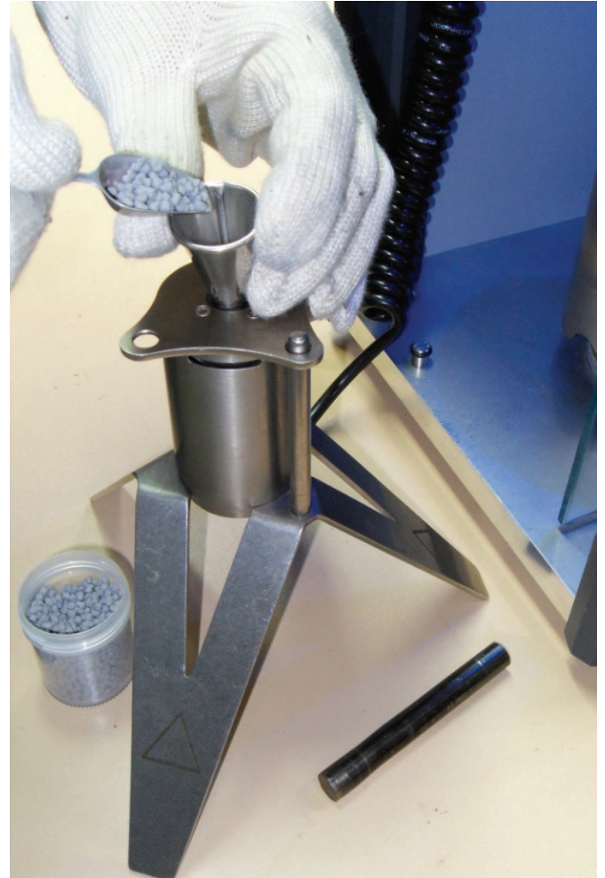
図2. 昇温したシリンダーにペレットを充填
