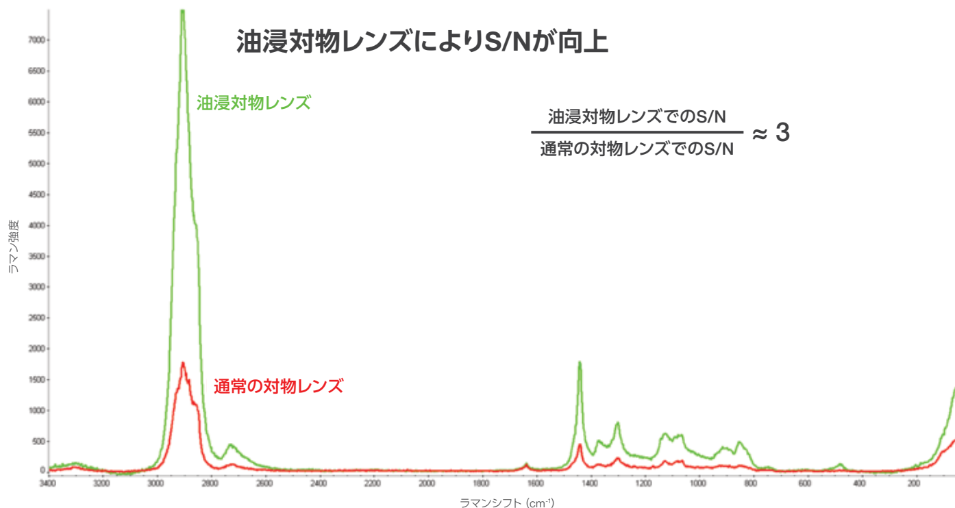
図4. 層状ポリマー複合フィルムのポリビニルアルコール層からのスペクトル。ラマン強度とS/Nのいずれも少なくとも3倍向上している。S/Nは 1,441\text{ cm}^{-1} でのピークの強度から計算し、二乗平均平方根のノイズは 2,300\sim 2,200\text{ cm}^{-1} からの領域で計算した。
