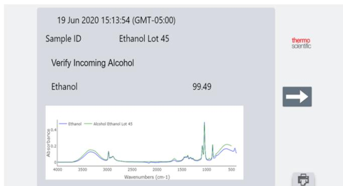
図3. エタノールのスペクトルに物質同定検索を適用した結果
