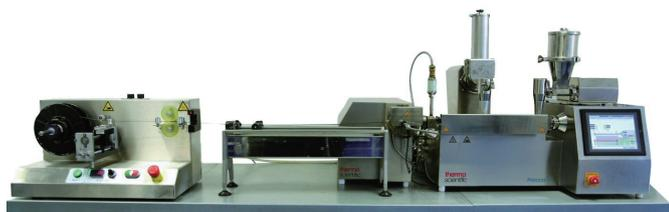
図2. 右から、Process 11 押出溶解混練機、ギアポンプ、ウォーターバス、フィラメントスプーラー
