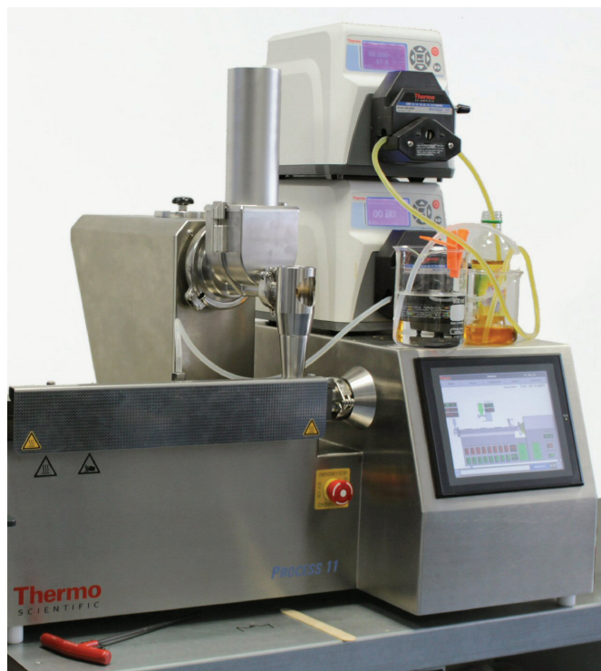
図1: 粉体と液体成分がエクストルーダーに投入される様子
