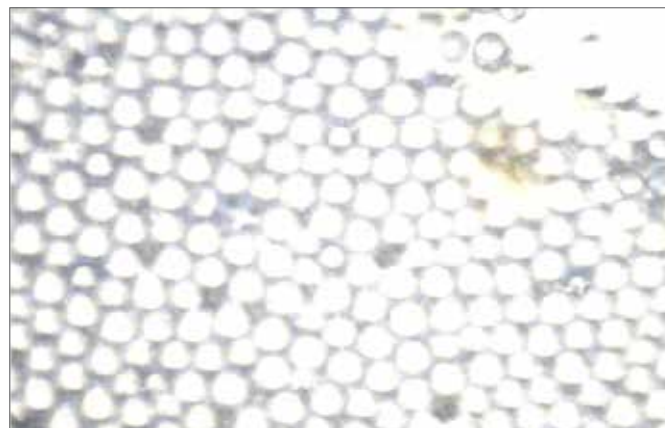
図2：スライドガラス上に溶液から蒸着させたプラスチックマイクロビーズ
