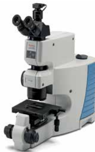
図1 : Thermo Scientific Nicolet iN5顕微FT-IR
