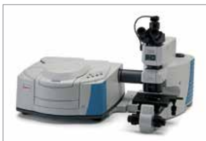
図2： Nicolet iS10 FT-IR 分光装置を接続した Nicolet iN5
