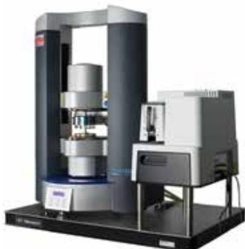
図1. Thermo Scientific HAAKE MARS<sub>XR</sub> Rheo-Ramanシステム。
