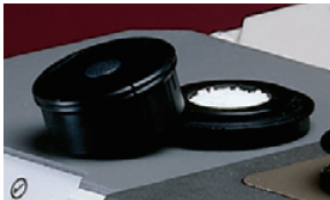
図2. ふた付きサンプルカップと回転スピナーを備えたAntaris II近赤外アナライザー
