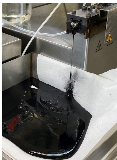
図1. Thermo Scientific Process 11二軸エクストルーダーを使用して配合されたカソードスラリー
