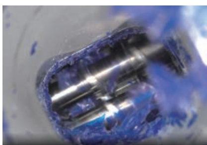
図2. Process 16 二軸スクリーエクストルーダーの材料供給ポート部にワイドスロートフィードスクリーエレメントを用いることで、より大きなフォイルシュレッドの取り込みが可
