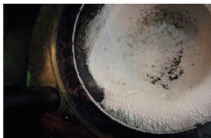
図1.上面をSiO<sub>2</sub>でコート済みのピストン
