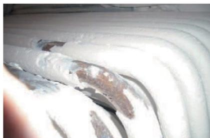
図2.SiO<sub>2</sub>でコート済みのボイラー管
