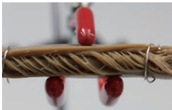
図1. Process 16二軸スクリーエクストルーダーでエンドウ豆タンパク質分離物から作られた植物由来肉押出物
