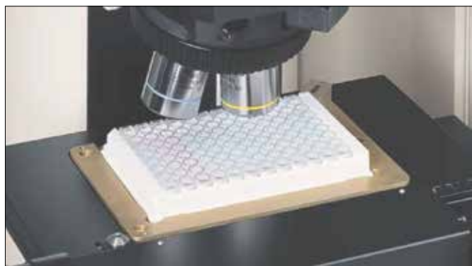
図2. 96ウェルプレートを用いた実験例。溶剤とイオン性を変え、各ウェルの再結晶を観察。
