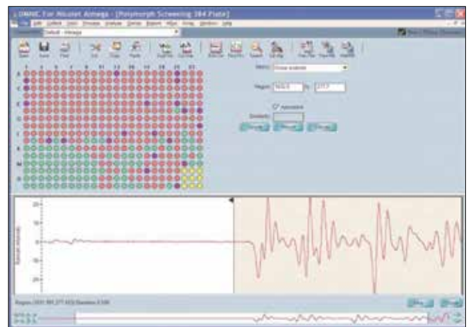
図12. バックグラウンドの蛍光干渉を除去するためにNorris微分を行いグループ分析を行った結果。3つのグループ (赤、緑、黄色) と、いずれにも該当しない21のウェル (紫色) に分類。
