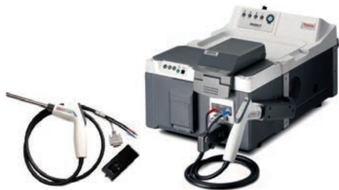
図1. SabIR Probeを搭載したAntaris MDSアナライザー サンプルはガラスバイアル瓶に入れ、SabIR プローブを使用して瓶の底面から光を当てて測定しました。
