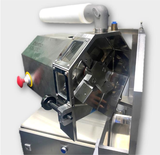
図2. Pharma FaceCut 16ペレタイザーは、ダイ出口で直接回転ブレードを使用して、押し出されたペーストをペレットにカットします。
