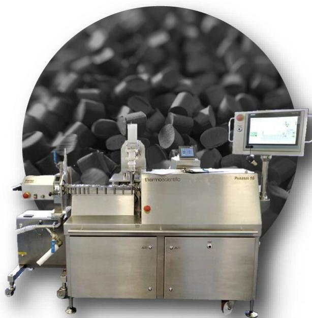
図1. 粉末および液体フィーディングシステムを備えたThermo Scientific™ Pharma16二軸スクリュウエクストルーダーとPharma FaceCut 16ペレタイザー
