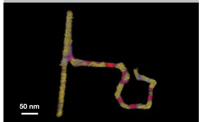
P-Zn-In 纳米管的 3D EDS 成像。 样品由密歇根科技大学 Reza Shahbazian Yassar 博士提供。
