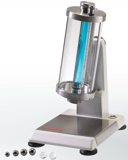
HAAKE Kugelfallviskosimeter Typ C
