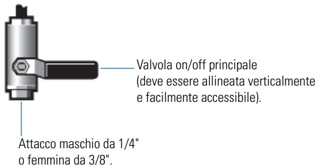
È necessario un regolatore di pressione da 20 psig. Se il kit di spурго è stato acquistato insieme al sistema, il nostro addetto all'assistenza installerà un regolatore di pressione e un flussimetro. Questi componenti manterranno la pressione e il flusso adeguati per un'acquisizione ottimale dei dati. Per informazioni più dettagliate, vedere il capitolo "Assistenza" della Guida utente.
