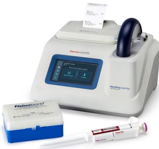
Il sistema di ritenzione del campione del NanoDrop Lite Plus è identico a quello utilizzato in tutti gli strumenti NanoDrop: la tensione superficiale viene utilizzata per trattenere 1-2  $\mu\text{L}$  di campione tra due piedistalli in acciaio inossidabile che contengono fibre ottiche. Il sistema brevettato di conservazione dei campioni consente di misurare campioni altamente concentrati senza la necessità di diluizioni.
