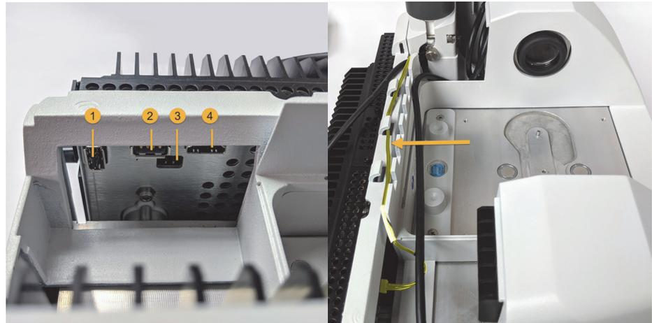
1. WLAN-Dongle Anschluss
