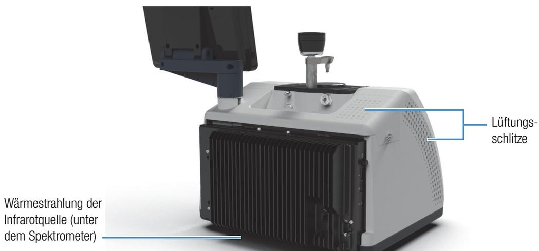
Die außen liegende Oberfläche der Infrarot Lichtquelle befindet sich an der Unterseite des Spektrometers. Sie kann im Betrieb sehr heiß werden. Die Unterseite des Messgerätes darf während des Betriebs und kurz nach dem Ausschalten nicht berührt werden.
