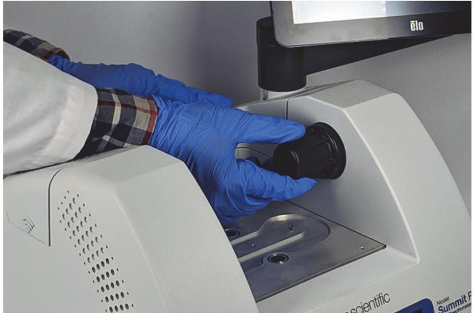
**Hinweis** Die Fensterfassungen sitzen sehr fest. Stabilisieren Sie das Spektrometer mit der einen Hand und drehen Sie das Fenster mit der anderen Hand ab.
