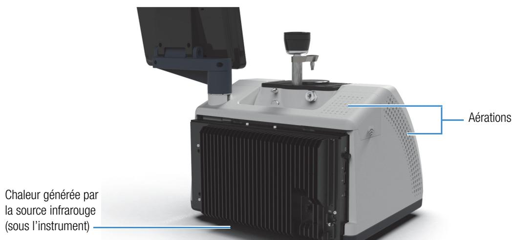
La surface de la source infrarouge orientée vers l'extérieur est située sous l'instrument et peut devenir très chaude. Ne touchez pas la base de l'instrument lorsque ce dernier est en marche, ou à l'issue de son utilisation.
