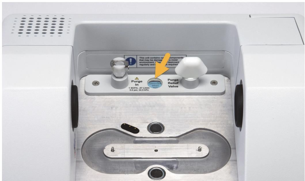
Vérifiez l'indicateur d'humidité au minimum une fois par mois, et changez les cartouches de desséchant selon les besoins (voir le tableau ci-dessous), ou achetez et installez un kit de purge. De plus amples informations sont disponibles dans la rubrique « [Installation et entretien d'un kit de purge](#) ».
