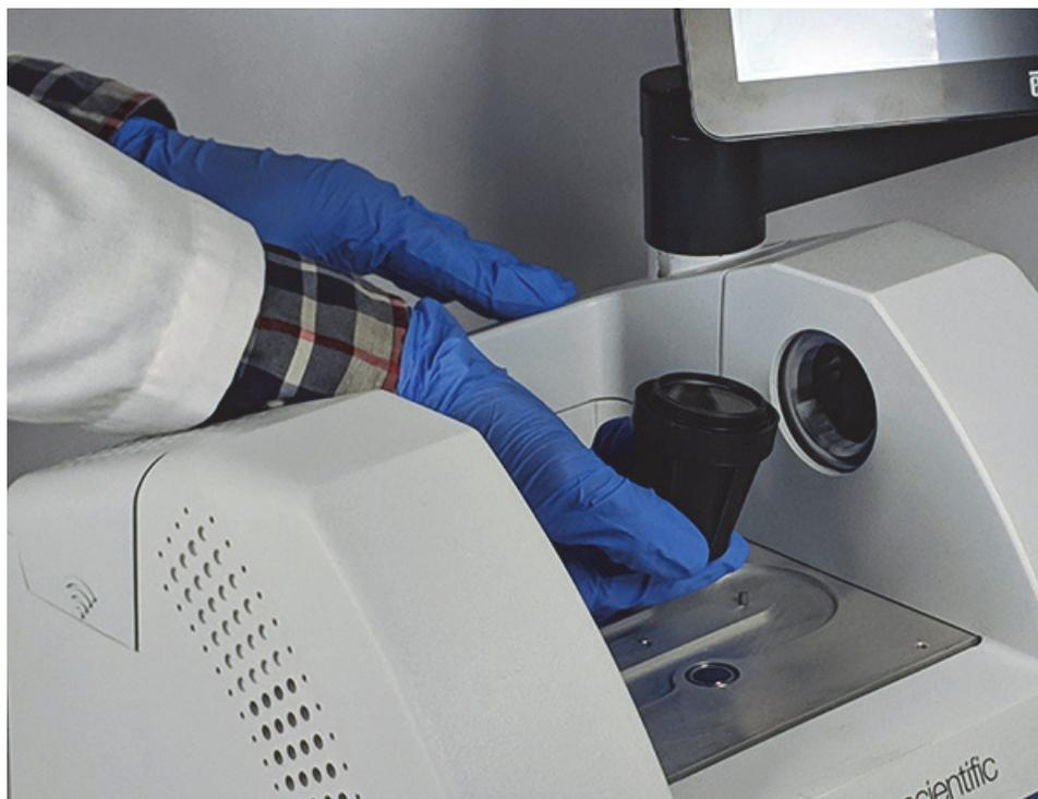
**AVVISO** Indossare guanti in nitrile per maneggiare la finestra tenendola esclusivamente dai bordi. (Evitare di toccare le superfici della finestra anche se si indossano i guanti).
