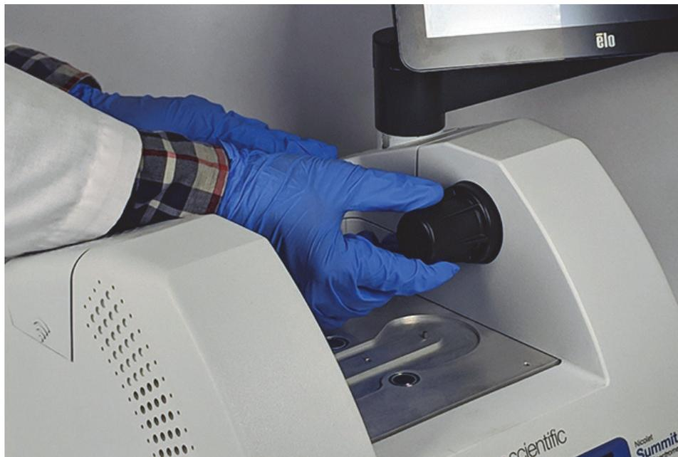
**Nota** I raccordi della finestra sono serrati. Stabilizzare lo strumento con una mano e con l'altra togliere la finestra.
