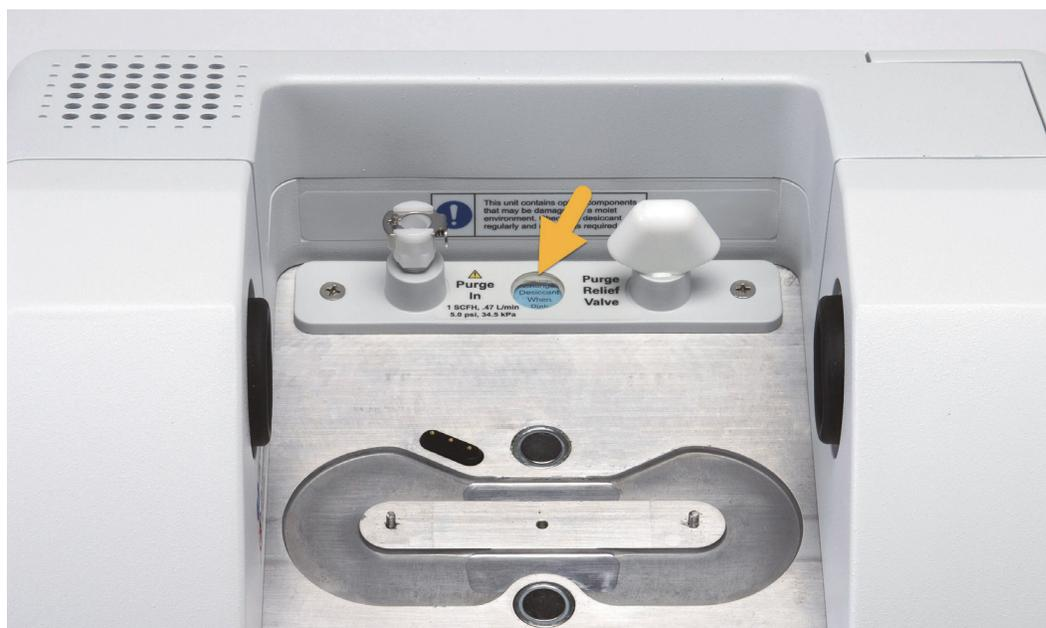
Controllare l'indicatore di umidità almeno una volta al mese e sostituire i contenitori di essiccante al bisogno (vedere la tabella seguente) o acquistare ed installare un kit di spurgo. Per maggiori informazioni, consultare la sezione [“Installazione e manutenzione di un kit di spurgo”](#).
