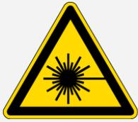
怪我に注意してください。レーザービームやその反射光を絶対に凝視しないでください。不良レーザーを交換している場合でも、レーザーヘッドは、絶対に分解したり内部に触れたりしないでください
