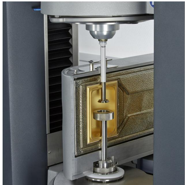
Abbildung 1: UV-Messzelle für die Temperierkammer (CTC) des HAAKE MARS Rheometers
