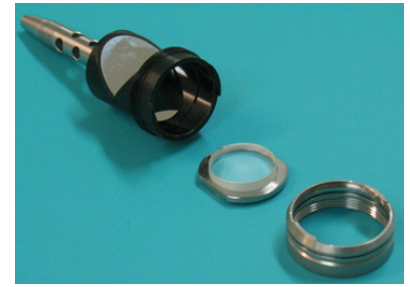
Abbildung 5: Obere Messgeometrie bestehend aus Schaft mit integriertem Spiegel sowie Schraubring zum Verschrauben / Befestigen der unteren Quarzglasplatte, in diesem Beispiel eine 20 mm Glasplatte mit separatem Klemmring
