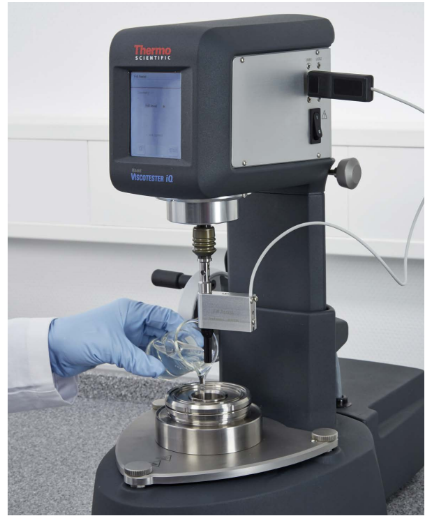
Fig. 5 : outil d'assistance au remplissage (Fill Assist tool) pour le rhéomètre HAAKE Viscotester iQ.
