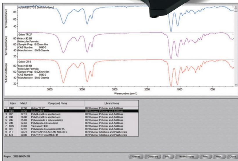
OMNIC PictaはアドバンスドATR補正を標準で搭載、室温型検出器による低波数領域までの分析と併せ、材料分析を確かなものにします。
