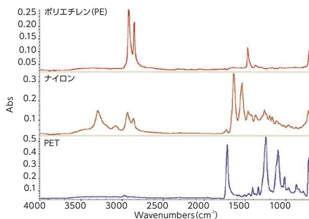
3,000~2,800 cm<sup>-1</sup>のピーク面積プロファイルから作成した各層の分布イメージ(左)とそれぞれの層から得られたATRスペクトル(右)
