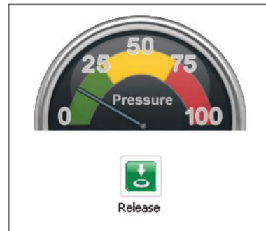
ATR測定用コンタクトアラートを標準で搭載。ソフトウェア上で圧力を数値で確認。再現性のある圧力を供給できると同時に、過剰圧によるATRクリスタルの破損を防止します。
