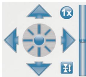
バーチャルジョイスティックは、スピードと加速度を自由自在に変更でき、ファインアジャストなどの操作も簡単です。オプションでハードウェアジョイスティックも選択できます。
