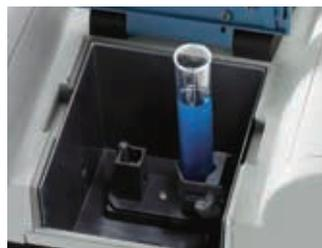
室内照明の影響を受けない耐室内光学系のため、背の高い試験管での測定でも試料室カバーを開けたまま高品質データを取得できます。
