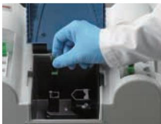
セル選択の自由度が高いサンプルコンパートメントです。標準装備セルホルダーで10 mm角型キュベットと13~25 mm径テストチューブ(試験管)の両方に対応します。
