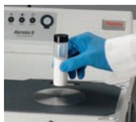
固体、粉体測定に適した専用サンプリングモジュールです。
