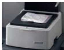
ユニバーサルプレート ポリバックやバイアル内の試料をオートフォーカスで測定します。
