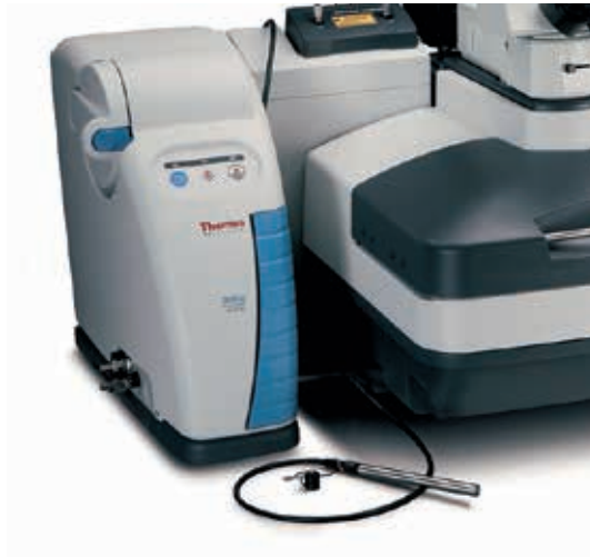
リモートサンプリング用ファイバプローブ
