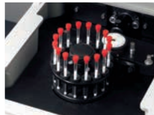
タブレットホルダー アイリス方式でさまざまなサイズの錠剤を固定できます。
