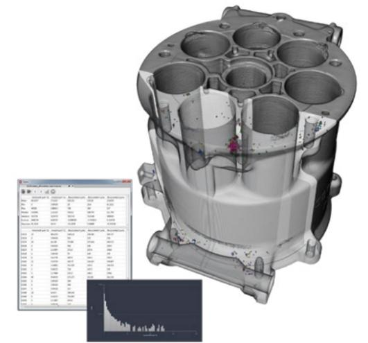
Defektanalyse an einem Kompressorgehäuse. Daten mit freundlicher Genehmigung von CyXplus
