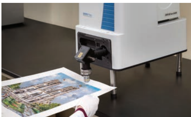
美術品鑑定用に顕微アクセサリを装備したDXR3 Flexラマン分光装置
