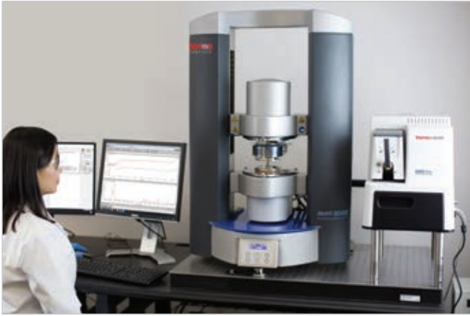
DXR3 Flex ラマン分光装置とレオメーターの組み合わせ
