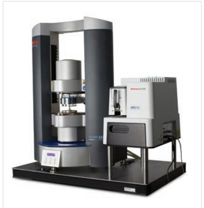
Thermo Scientific™ HAAKE™ MARZ™ レオメーターとDXR3 Flexラマン分光装置を組み合わせせた複合分析システム
