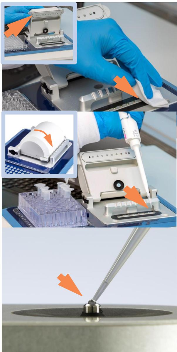
2. Sollevare il braccio dello strumento e pulire i piedistalli superiore e inferiore con una nuova salvietta da laboratorio.
