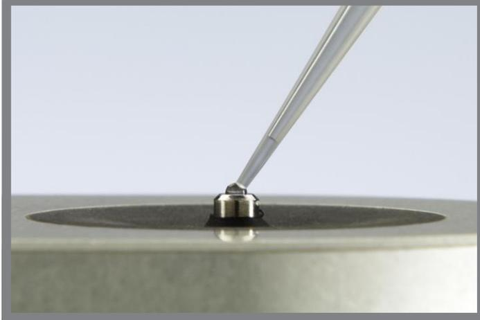
1. Aprire la fiala contenente del composto PR-1 e utilizzare l'applicatore fornito per prelevare una quantità di preparato della grandezza di una capocchia di spillo.
