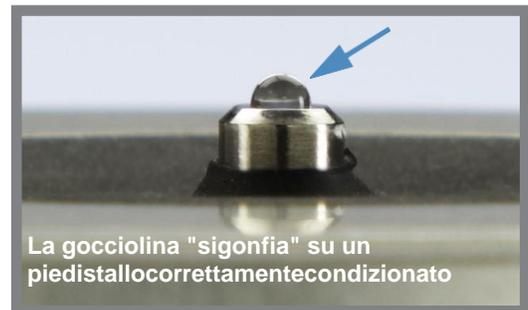
Suggerimento Il composto di ricondizionamento del piedistallo PR-1 costituisce il modo più semplice per ricondizionare i piedistalli. Se non si dispone di un kit PR-1, seguire i passaggi indicati di seguito:
