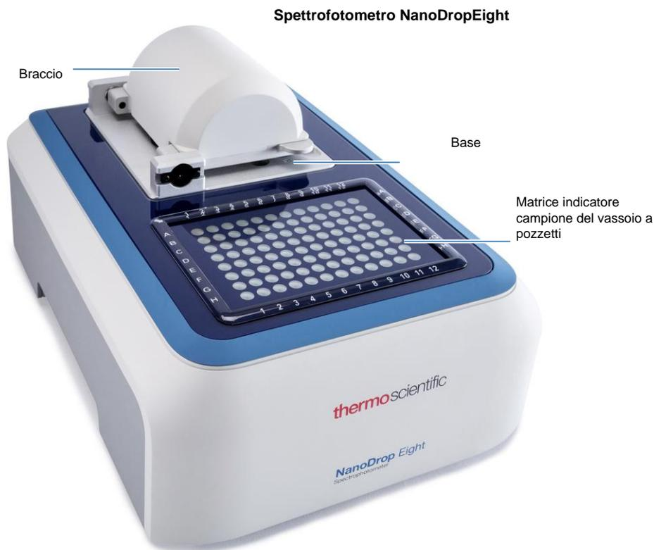
**Nota** Collocare lo strumento lontano da prese d'aria e ventole di estrazione per ridurre al minimo il rischio di evaporazione
