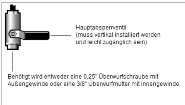
Es wird ein Druckregler mit 1,4 bar benötigt. Wenn mit dem Gerät ein Spülsystem erworben wurde, installieren unsere Servicemitarbeiter einen Druckregler und einen Durchflussmesser. Durch diese Komponenten wird das Einstellen eines für die Datenaufnahme optimalen Drucks sowie Durchflusses gewährleistet. Weitere Informationen hierzu finden Sie im Abschnitt „Wartung“ der Gebrauchsanweisung.
