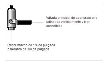
Se requiere un regulador de presión a 20 psig. Si se adquiere el kit de purga con el sistema, nuestro técnico de servicio también instalará un regulador de presión y un caudalímetro. Estos componentes mantendrán la presión y el caudal óptimos para la adquisición de datos. Consulte la sección "Service" (Asistencia técnica) de la guía del usuario para obtener información detallada.
