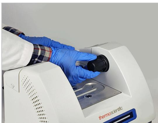
**Hinweis** Die Fensterfassungen sitzen sehr fest. Stabilisieren Sie das Spektrometer mit der einen Hand und drehen Sie das Fenster mit der anderen Hand ab.
