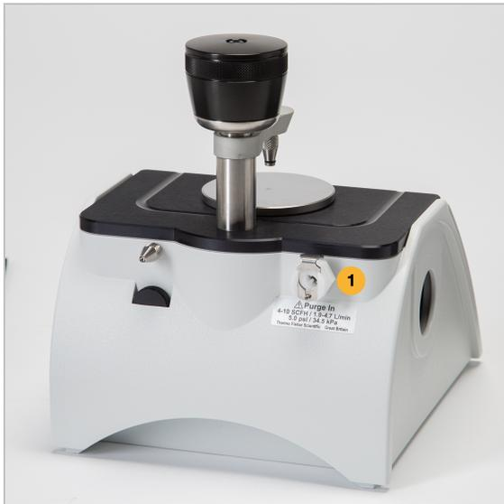
**Hinweis** Zum Entfernen eines Zubehörs trennen Sie ggf. die Leitung vom Spülanschluss, fassen das Zubehör an den Griffen und ziehen es nach oben. Wird das Zubehör nicht verwendet, bewahren Sie es in einer möglichst staubfreien Umgebung wie z. B. einem Schrank oder einem Karton auf.
