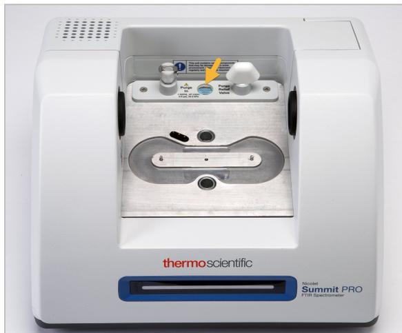
Überprüfen Sie den Feuchtigkeitsindikator mindestens einmal monatlich und wechseln Sie ggf. die Trockenmittelbehälter (siehe folgende Tabelle), oder erwerben und installieren Sie eine Spüleinheit. Weitere Informationen finden Sie unter "[Installieren und Warten einer Spüleinheit](#)".
