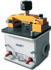
El accesorio de ATR Golden Gate incluye un yunque de zafiro para el contacto con alta presión y un exterior muy resistente, que permite analizar gran variedad de muestras, ya sean partículas o fibras, sólidos duros o líquidos corrosivos. El accesorio de ATR Golden Gate también es ideal para el macromuestreo.
