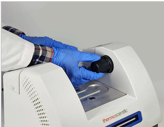
**Nota** I raccordi della finestra sono serrati. Stabilizzare lo strumento con una mano e con l'altra togliere la finestra.
