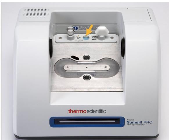
Controllare l'indicatore di umidità almeno una volta al mese e sostituire i contenitori di essiccante al bisogno (vedere la tabella seguente) o acquistare ed installare un kit di spurgo. Per ulteriori informazioni, vedere ["Installazione e manutenzione di un kit di spurgo"](#).
