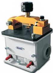
Golden Gate ATRアクセサリは、高圧接触用のサファイアアンビルと頑丈な外装が特長です。単一粒子や繊維、硬い固体から腐食性液体まで、さまざまなサンプルが分析できます。Golden Gate ATRアクセサリは、マクロサンプリングにも最適です。
